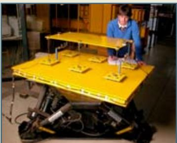
Simulación sísmica para modelos estructurales.
