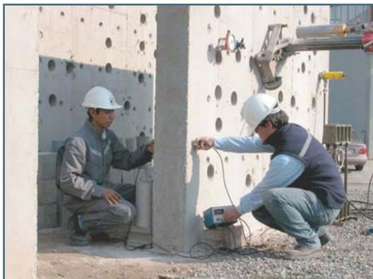
Ensayos destructivos en hormigón.
