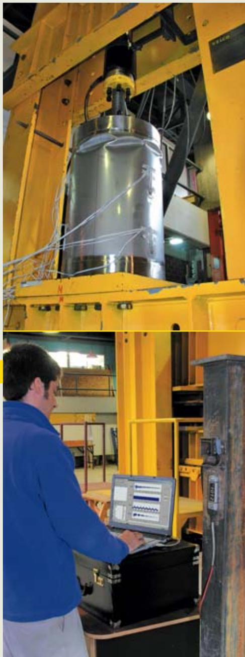
Arriba: Ensayo de compresión.
