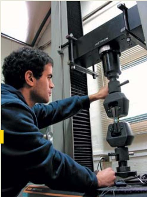
Ensayo de materiales, máquina INSTRON.
