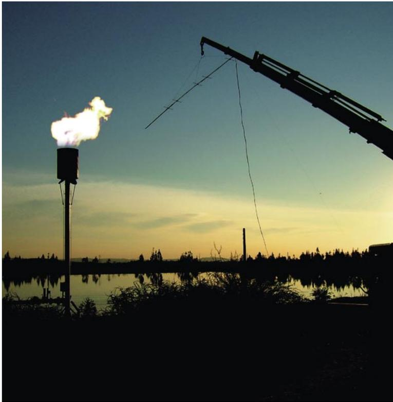
← Medición de emisiones de gases de antorchas abiertas a la atmósfera, que queman biogas, para determinar la eficiencia de destrucción del metano, realizada por el área Energía Sustentable DICTUC.
