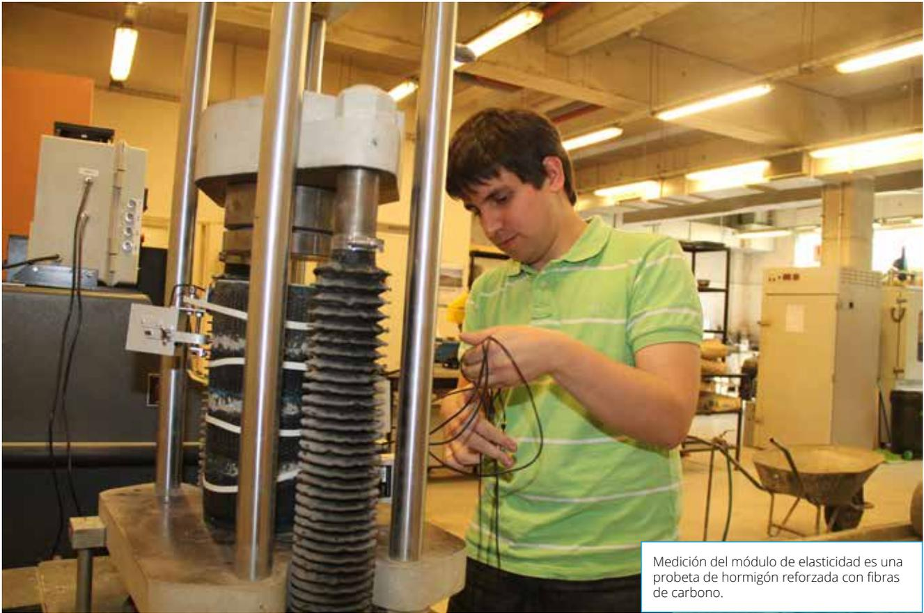
Medición del módulo de elasticidad es una probeta de hormigón reforzada con fibras de carbono.
