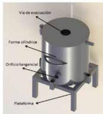
Figura 3. Estructura metálica del horno.
