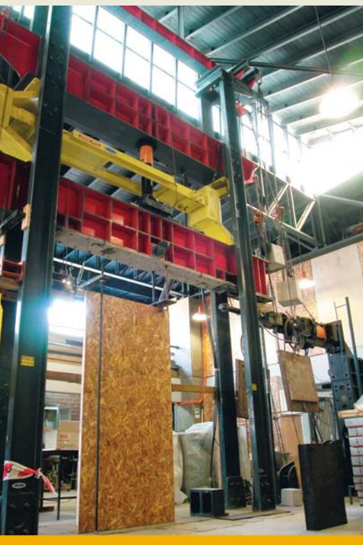
Ensayo estático de componentes estructurales, marco JICA.
