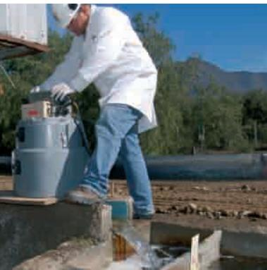
Recolección de datos por un sistema robotizado de toma de muestras de agua, en planta de tratamiento de aguas servidas. Área de Aguas y Riles de DICTUC
