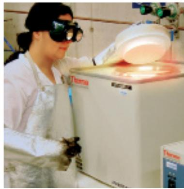
Horno para fundir minerales del Centro de Minería de DICTUC
