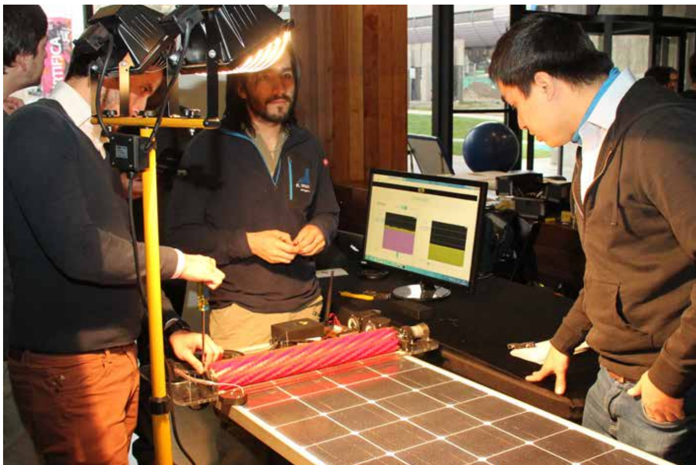
EN 2016 SE LANZÓ CON COBERTURA NACIONAL EL PROGRAMA BRAIN CHILE , cuyo objetivo es potenciar emprendimientos de base científica-tecnológica para que puedan llegar al mercado. En la foto, Inti-Tech, robot que limpia paneles solares.
